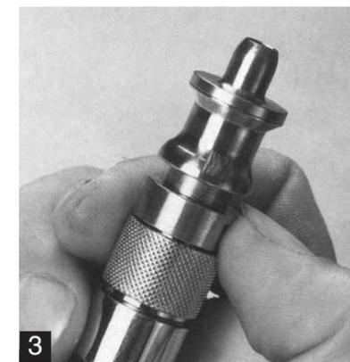
3 Relâcher la bague (l'embout est ainsi positionné). Veillez à ce que le disque de l'embout et la partie supérieure de l'appareil soient parfaitement juxtaposés.
