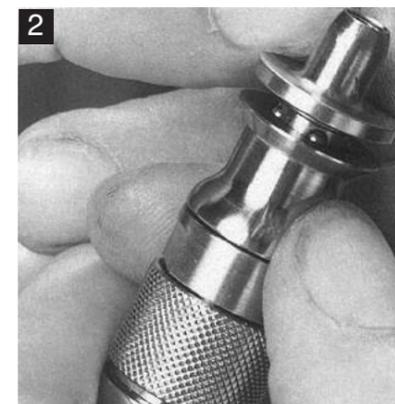
2 Introduire bien à fond la partie inférieure de l'embout dans la cage de la tête de l'appareil tout en maintenant la bague dans sa position basse.
